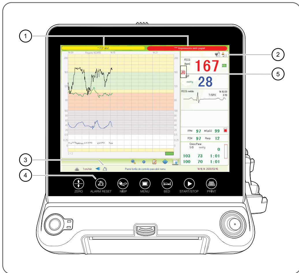
Figura 3:36 Descrição geral do sistema de alarme
