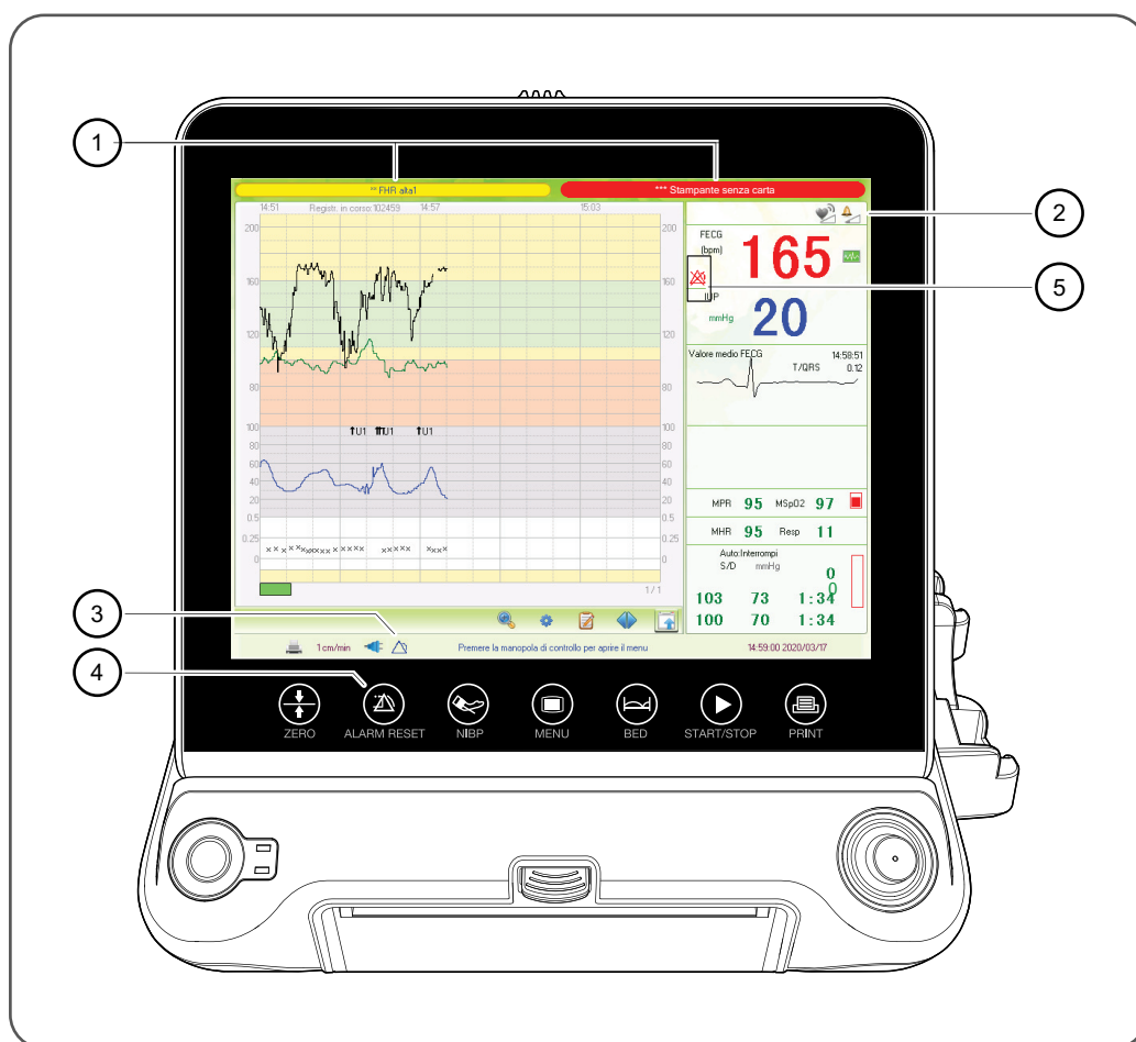
Figura 3:36 Panoramica del sistema di allarme
