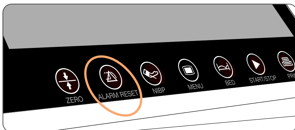
Figura 3:37 Tasto a sfioramento "ALARM RESET"
