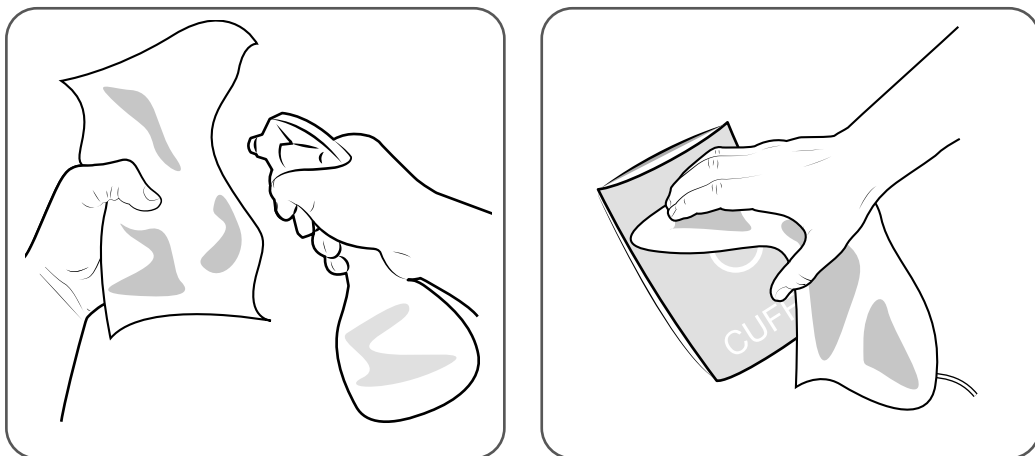
Abbildung 5:101 Reinigen von Blutdruckmanschette und Schlauch
