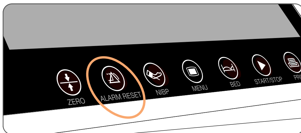
Figur 3:37 Trykknappen "ALARM RESET"
