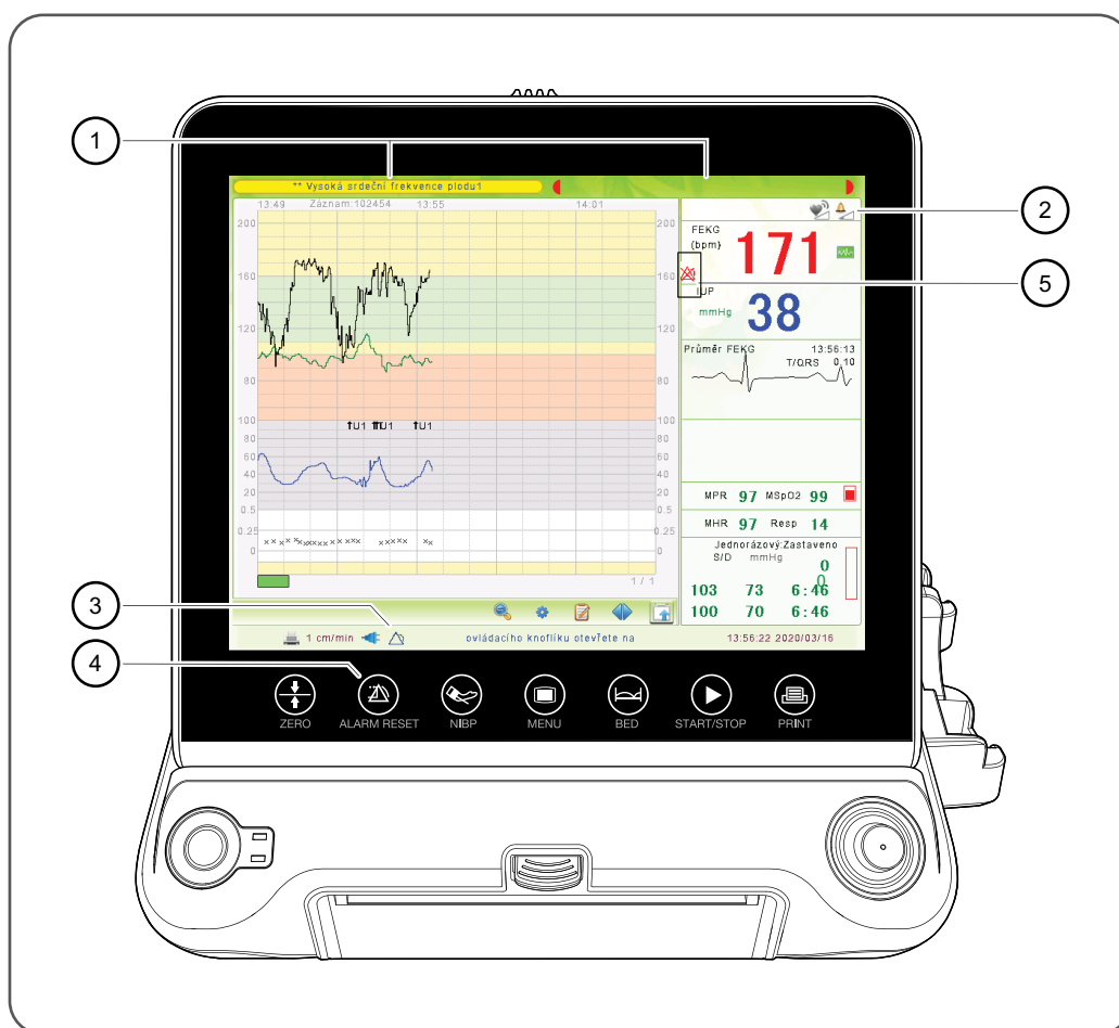
Obrázek 3:36 Přehled systému varovných hlášení (alarmů)
