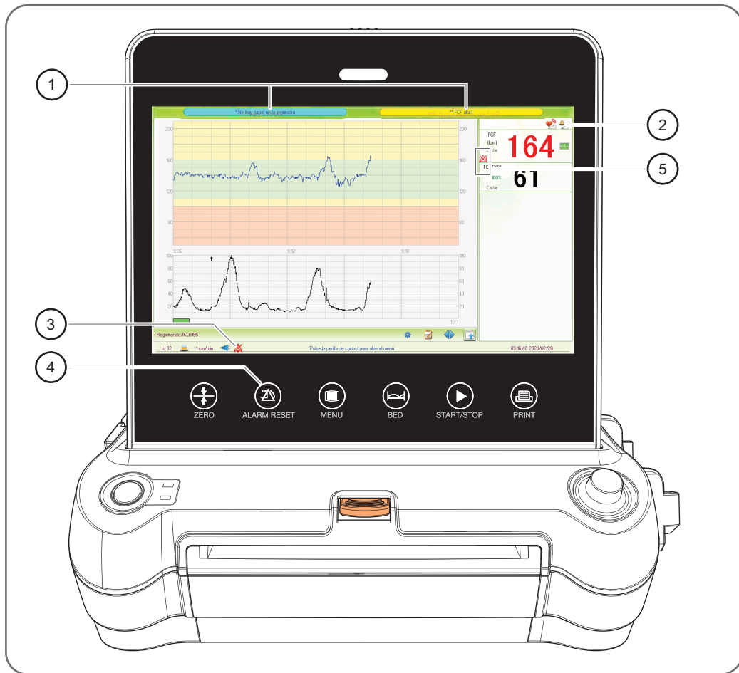
Figura 3:31 Descripción general del sistema de alarma
