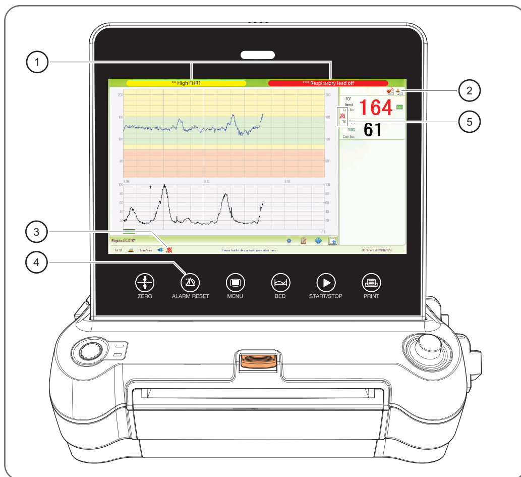
Figura 3:31 Descrição geral do sistema de alarme
