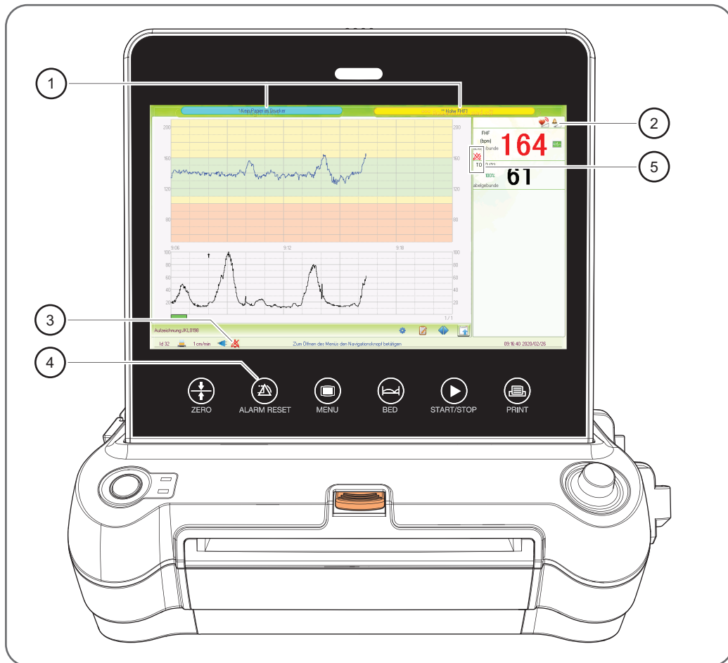
Abbildung 3:31 Übersicht über das Alarmsystem
