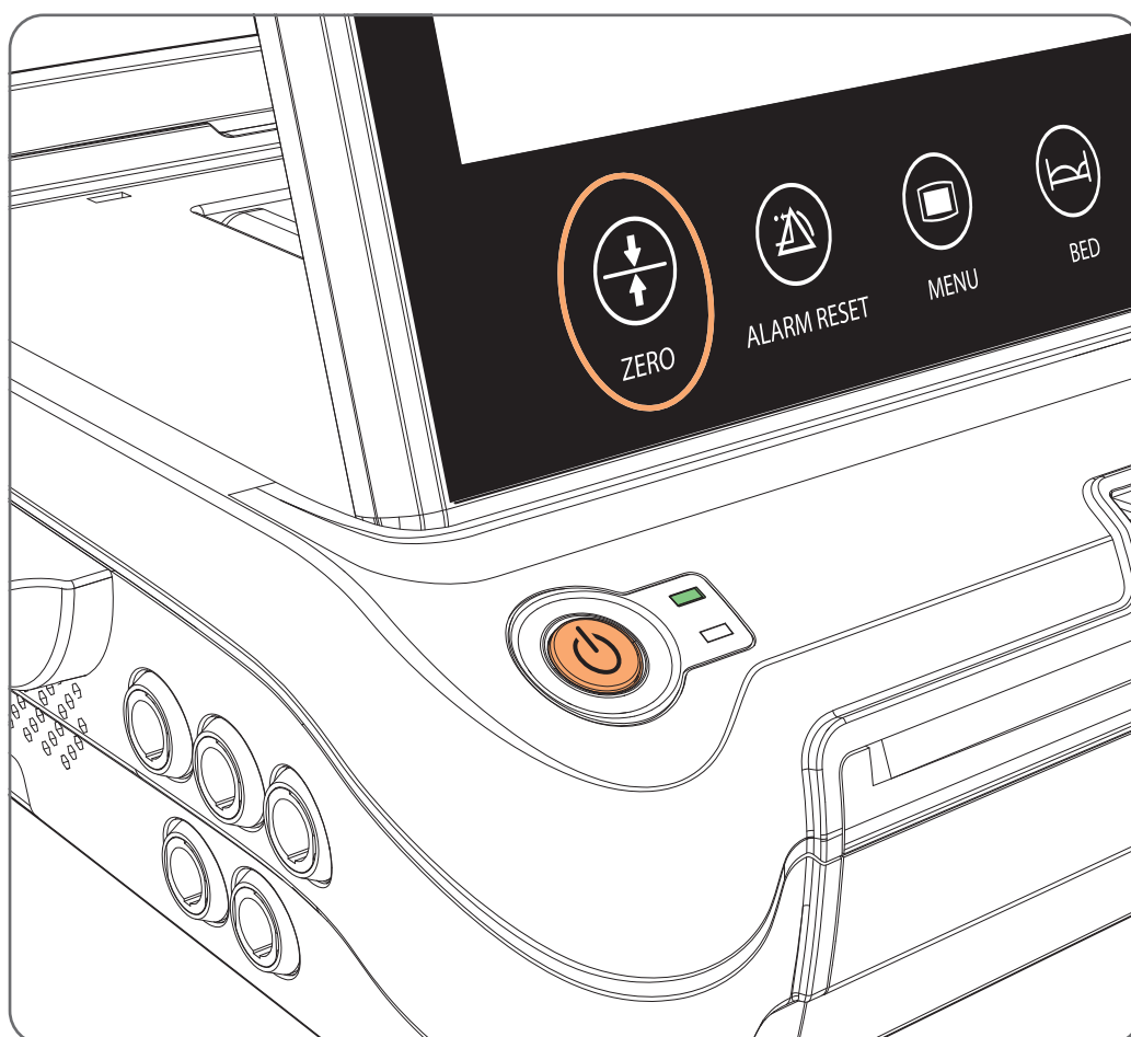
Illustration 4 :62 Réinitialisation des fonctions TOCO à l'aide de la touche tactile « ZERO »
