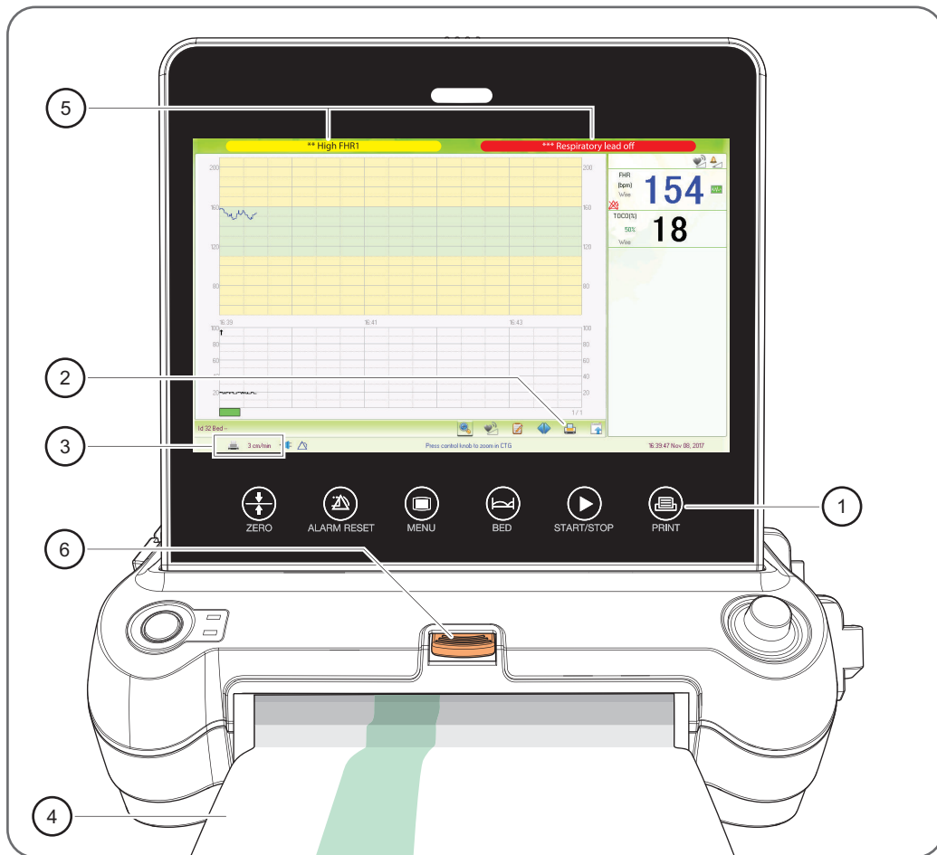
Afbeelding 3:37 Weergave van de printer met bijbehorende bedieningen
