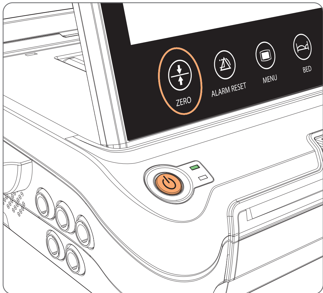
Afbeelding 4:62 TOCO-functies resetten met de “ZERO” aanraaktoets
