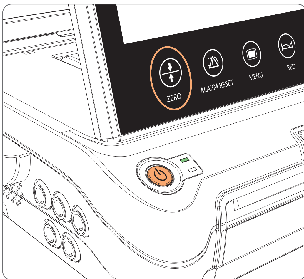
Figur 4:62 Nulstilling af TOCO-funktionerne med trykknappen "ZERO"
